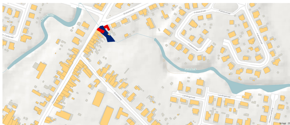
Figuur 18: Overstromingscontour ter hoogte van de Gezellestraat en Brienstraat in het centrum van Vlamertinge met aanduiding van de gebouwen die onder water gestaan hebben (rode polygonen)
