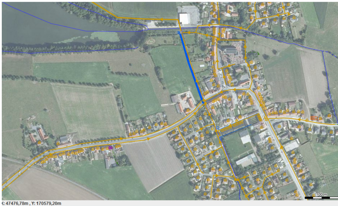
Figuur 6: Situering van het traject van de RWA-collector die door Aquafin zal heraangelegd worden in open profiel.
